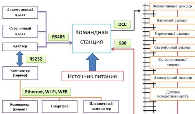
Рис 1. Функциональная схема управления макетом железной дороги
